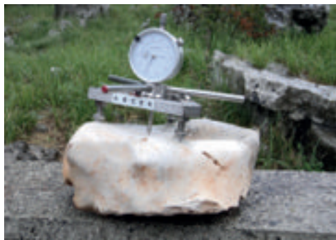
Misurazione con micrometro a lettura centesimale sul campione di calcare per lo studio della dissoluzione sottocutanea prima di venire sotterrato.
