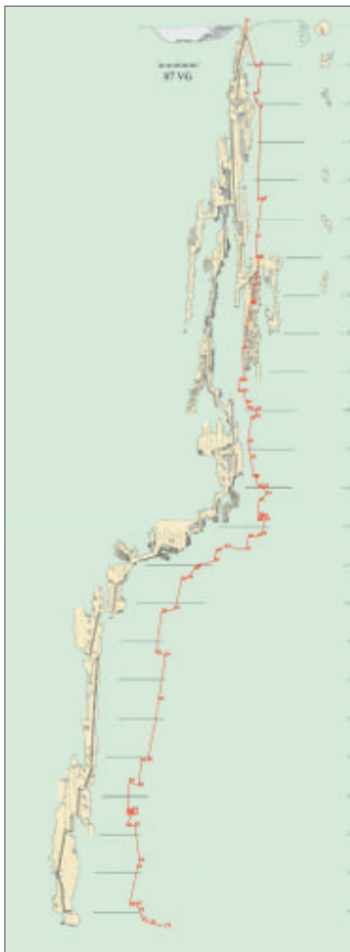
Rilievo 87 VG aggiornato al 3.11.2017 (a fianco la poligonale fatta con in DistoX da G. Cergol). Manca il cunicolo finale.
