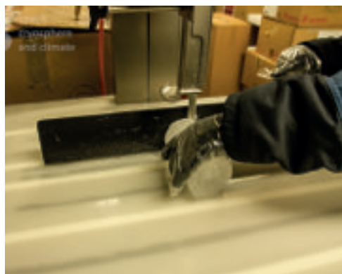
Figura 3. Fasi di taglio della carota di ghiaccio estratta in Canin contenente il deposito di calcite criogenica. Le operazioni si sono svolte in cella fredda con una temperatura di -30°C
