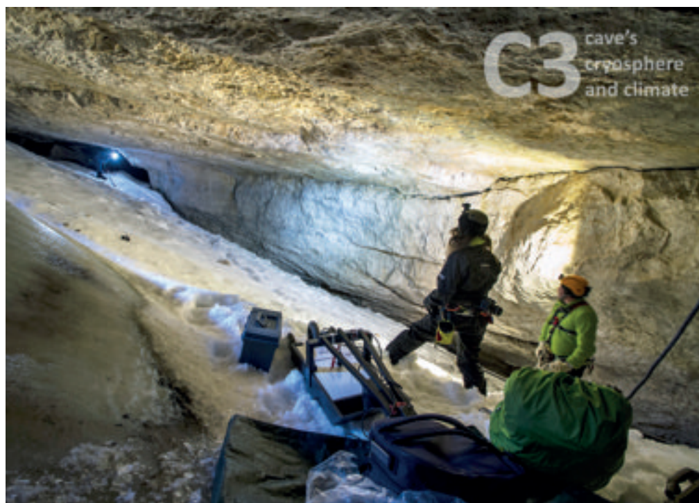
Figura 4. Le operazioni di monitoraggio con l'uso del GPR in un deposito di ghiaccio sotterraneo del Canin eseguite nell'autunno 2017
