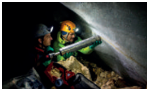
Figura 2. Le fasi di estrazione delle carote di ghiaccio da 1m attraverso il deposito di calcite criogenica evidenziato nell'immagine dalla linea di detrito giallastro all'interno del ghiaccio. Nella foto Marc Luetscher (Università di Innsbruck) e Renato R. Colucci (CNR Trieste) durante le operazioni di carotaggio.
