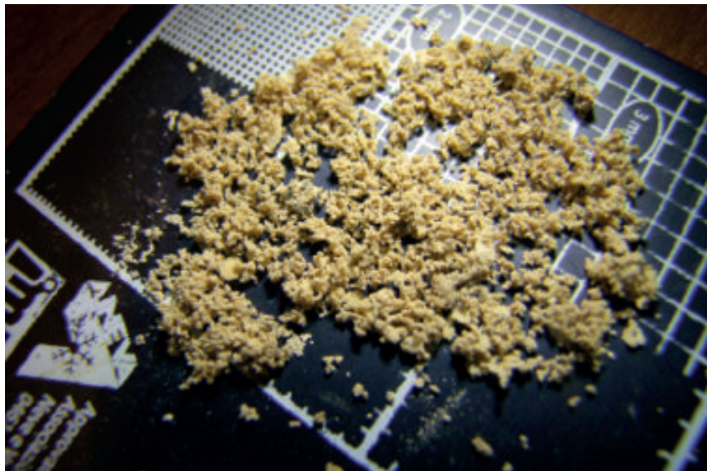
Figura 1. Cristalli di calcite criogenica grossolana raccolti nella grotta di ghiaccio oggetto dello studio e fotografati su una tavoletta per misure nivologiche per evidenziarne le dimensioni
