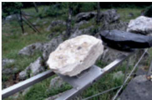
Campione di "Travertino" attrezzato con i chiodi per eseguire la misura periodica della dissoluzione.
