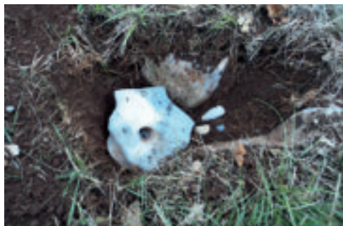
I campioni di calcare posizionati nella fossa prima di venire sotterrati.
