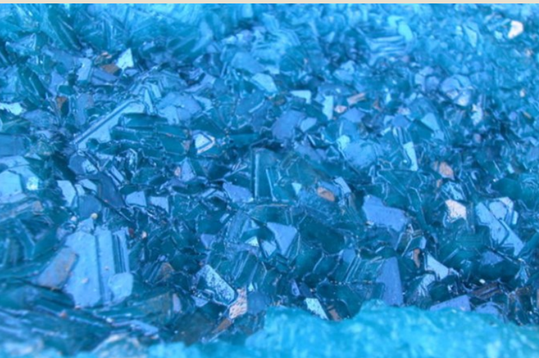
Formations of Melantherite (ferrous sulfate) in situ at Filón Norte. Melantherite is formed by the oxidation of large masses of pyrite. / Formaciones de Melantherita (sulfato ferroso) in situ en Filón Norte. La melantherita se forma por la oxidación de las grandes masas de pirita. (espiadellabo.com)
