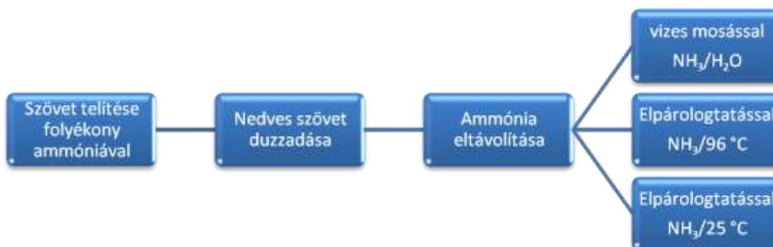
2. ábra: Folyékony ammóniás kezelés általános folyamata (Bertoniere és társai, 1986)
