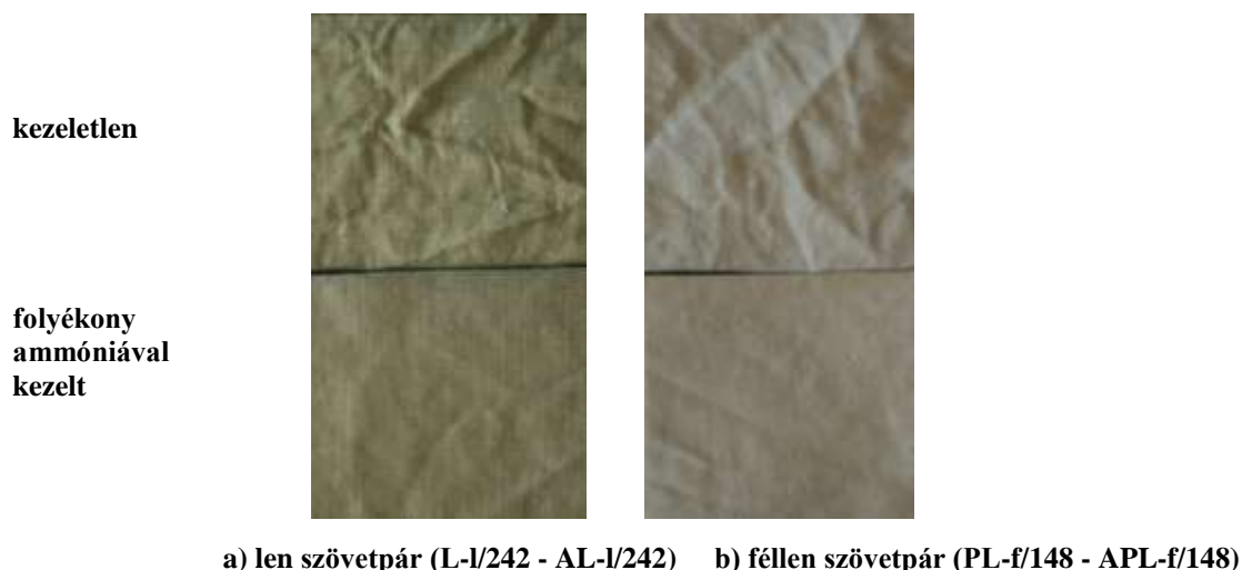
35. ábra: Kezeletlen és folyékony ammóniával kezelt szövetek fotói a szövetek mosása után
