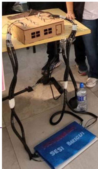
Figura 4: Maquete de sala de aula em escala reduzida com circuito integrado ao piso gerador, no qual a energia cinética captada é convertida em energia elétrica para alimentar lâmpadas de LED, ilustrando de forma visual o funcionamento do sistema piezoelétrico desenvolvido no projeto.
