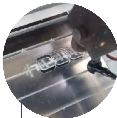
Figura 5: Uso da máquina a laser para gravar os comandos nos cards e recorte.
