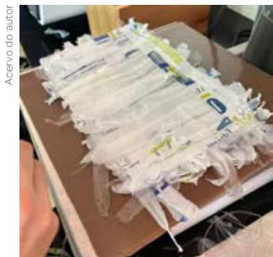
Figura 1: Sobreposição de camadas para preparação pré-prensagem.
