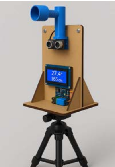
Figura 2: Esboço final criado com auxílio de IA (Copilot), baseado em nossos comandos e ideias iniciais para a construção do teodolito artesanal.
