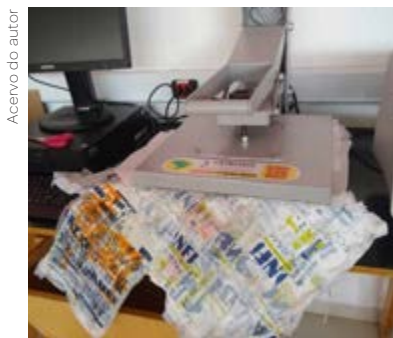
Figura 2: Processo de prensagem térmica em andamento.
